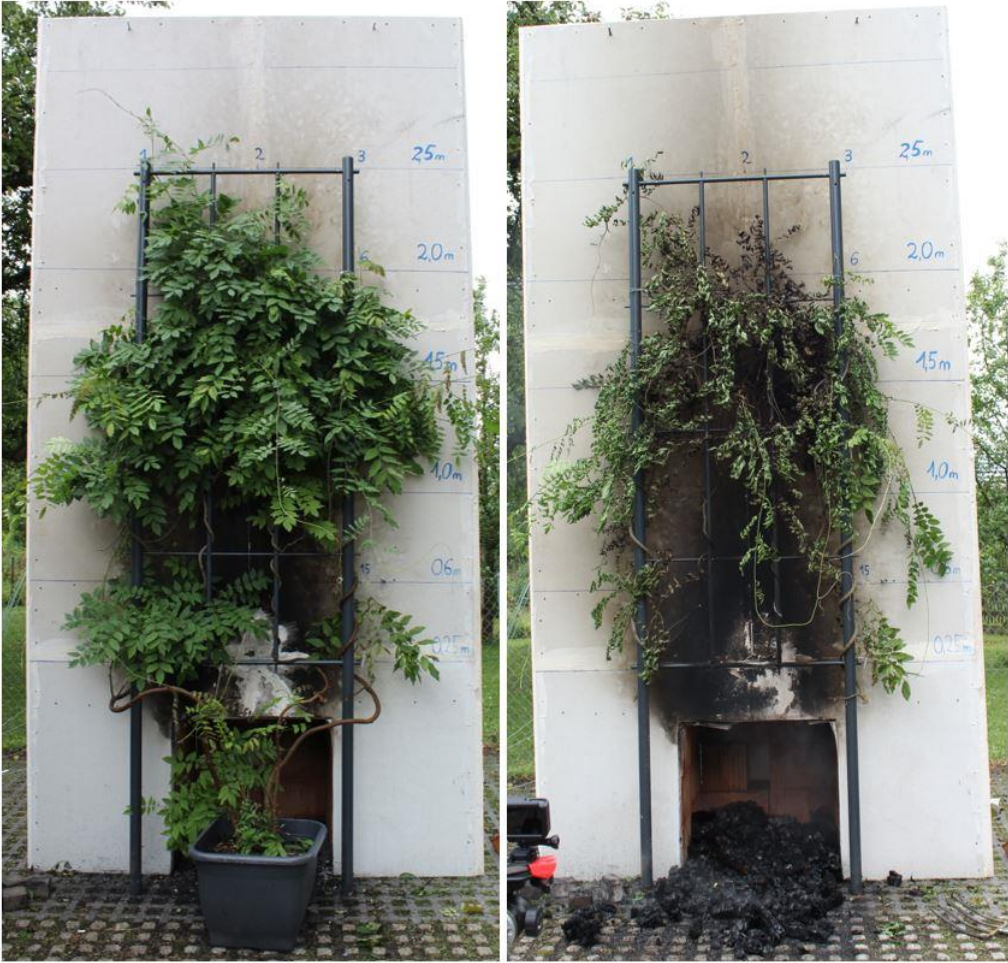
Bild 5: Versuch BV_Blauregen, vorher- und nachher. Fire test BV_Blauregen, before and after. Quelle: [1]
