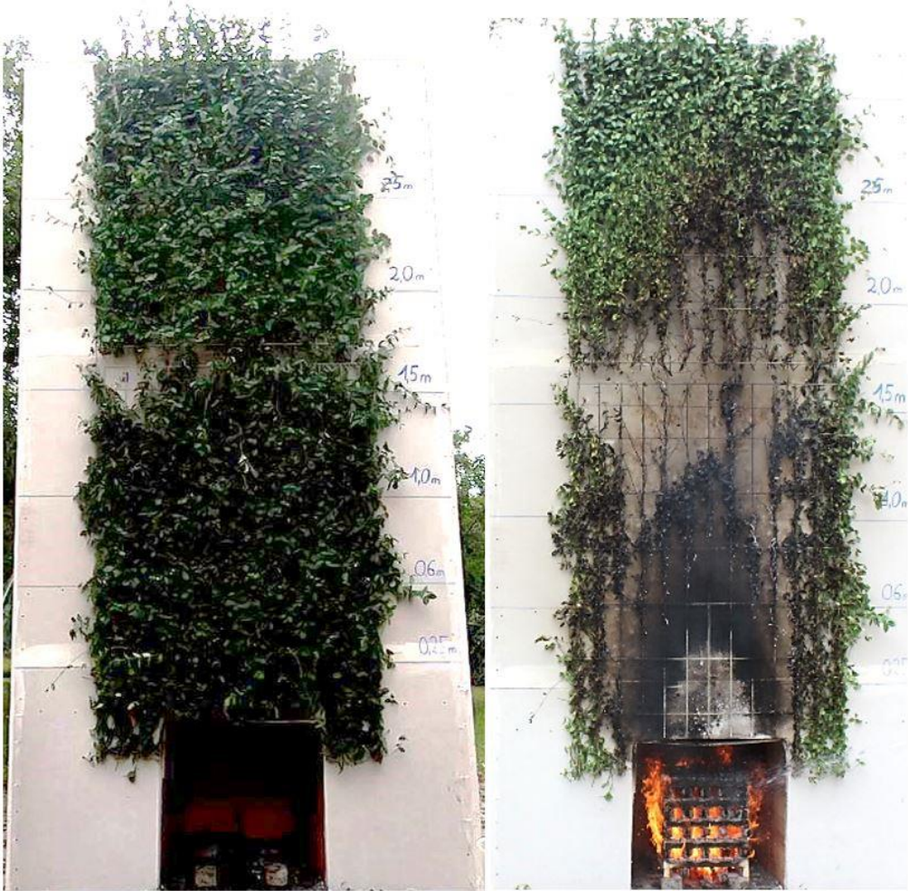
Bild 4: Versuch BV_Kriechspindel, vorher- und nachher. Fire test BV_Kriechspindel, before and after. Quelle: [1]
