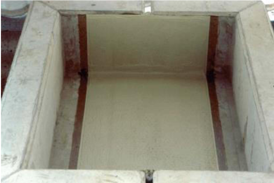
Prüfgefäß mit durchgängiger, ca. 3 cm breiter Fuge
