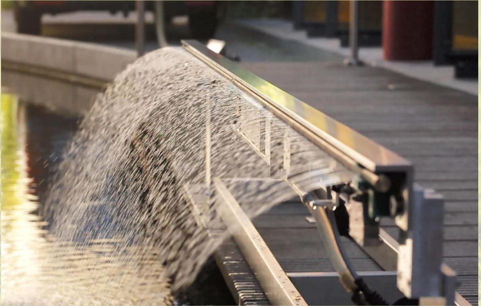
**Düsenkamm mit 240 Löchern zwischen 0,7 und 1,1 mm Durchmesser**
