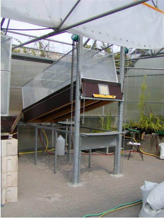
Foto 1: Bis zu 35° neigbarer Messtisch mit 2,5 m Fließlänge
