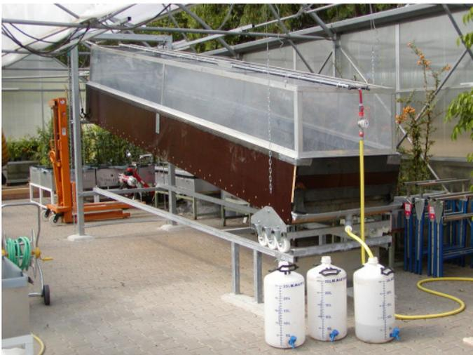
Foto 2: Bis zu 15° neigbarer Messtisch mit 5,0 m Fließlänge
