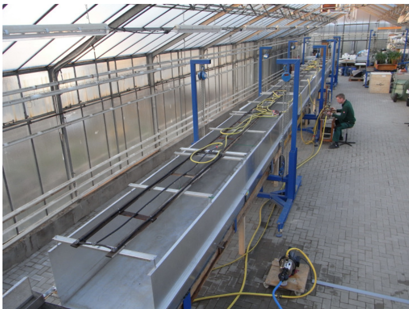
Foto 1: Endoskopkameras zur Wasserstandsbestimmung im Testlauf zur Kalibrierung der Versuchsanlage
