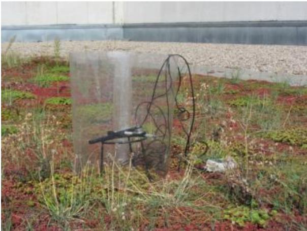
Abb. 4 CO<sub>2</sub>-Messung im Zylinder aus Plexiglas
