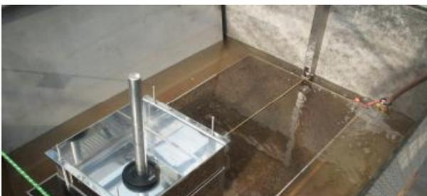
Foto: 1 Vorbereitung eines Scherversuchs in der Scher- und Reibungsmessanlage (BARTEL, 2013, S.102)
