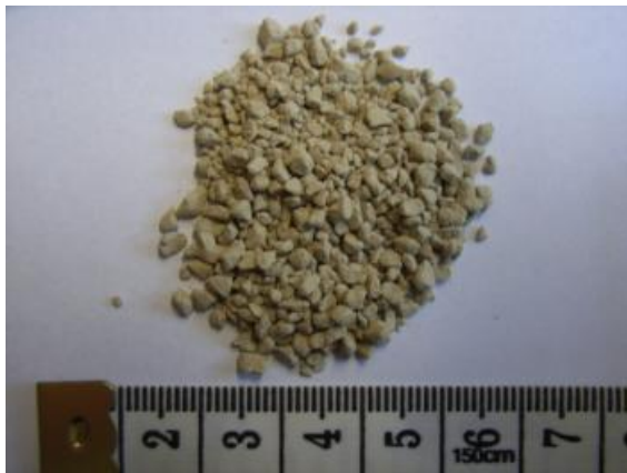
Abbildung 4: Granulat auf Basis von Kieselgurschlamm und Friedländer Ton.
