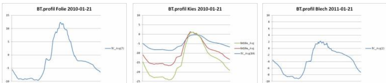
Abbildung 14: Temperaturprofile Dachbegrünung im Vergleich zu Referenz. Quelle: IBLB
