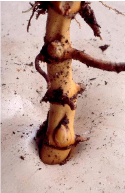
Abb. 3: Durch die Fläche einer 2,0 mm dicken PVC-P-Bahn gedrunenes Rhizom
