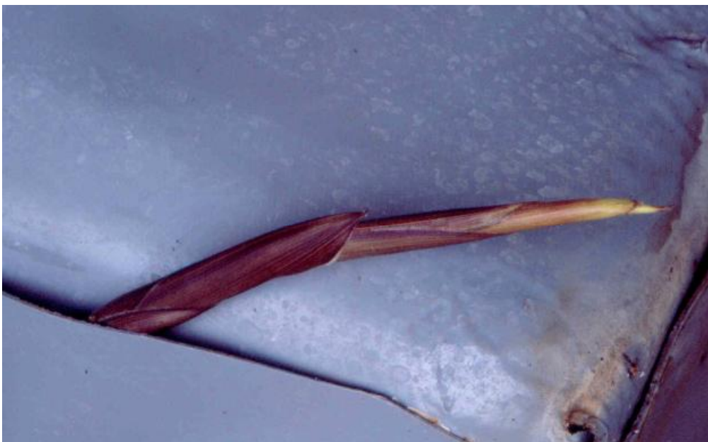
Abb. 2: Durch die Naht einer 1,6 mm dicken LDPE-Bahn gedrungenes Rhizom
