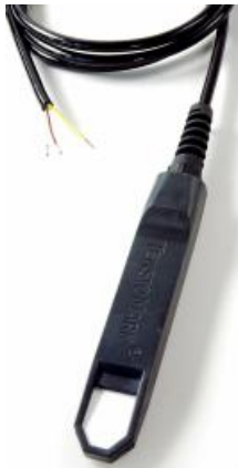
Abb. 2: Der Sensor 'TensioMark TMA' misst als "Trockenes Tensiometer" über seine poröse Keramikfläche das sog. Matrixpotential die Bindungskräfte im Substrat
