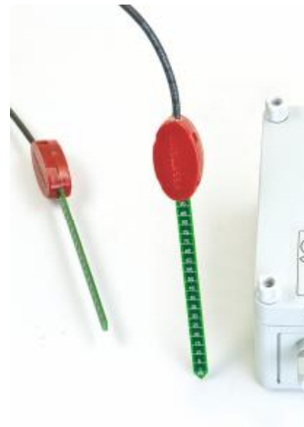
Abb. 3: Der 'Vegetronix VH400' ist ein einfacher kapazitiver Sensor der mit elektrischen Feldern hoher Frequenz den Wassergehalt im Substrat registriert und analoge Werte liefert
