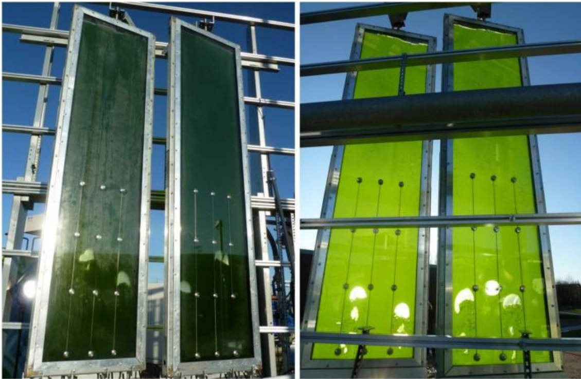
Abbildung 4 Prototyp PBR-Fassadenelement im Testbetrieb (Bild: SSC GmbH)
