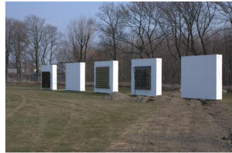
Abbildung 3: Aufbau der ersten vier Versuchswände, Mineralputz fertiggestellt. Quelle: 10/2010 VfB
