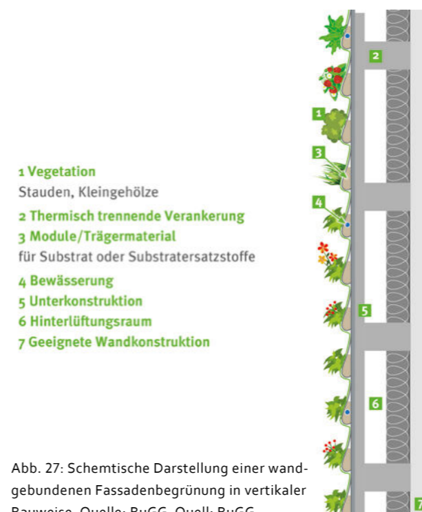
Abb. 26: Wandgebundene Fassadenbegrünung in vertikaler (modularer) Bauweise. Quelle: BuGG
