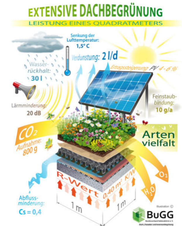
Abb. 55: Mögliche Leistung eines Quadratmeters Solar-Gründach. Quelle: BuGG
