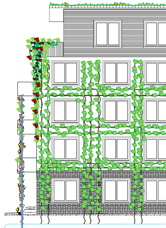
2 Sicker-Pflanzbeet für Fassadenbegrünung (bodengebunden) aus Regenwasserbewirtschaftung (Retentionsstufe 3) und Bewässerung aus Überschüssen des dezentralen Grauwasserrecyclings
