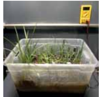
Abb. 2: Versuchsaufbau mit der Sumpfsegge ( Carex acutiformis ) als bepflanzte mikrobielle Brennstoffzelle (Grafik und Foto: A. Zehndorf).
