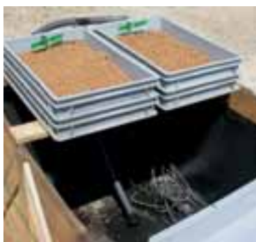
Abb. 19, 20, 21: Versuchsaufbau links (19): je 2 Filtermodelle (Tablets) wurden pro Kiste mit 2 ° Gefälle aufgestellt. Hinten ist die Wassereinspeisung (je zwei Einlässe pro Tablett) zu sehen. Vorn wurden die Tablets knapp über der Vegetationstragschicht gelocht. Mitte (20): Das untere Tablett wurde mit je einem Temperaturfühler bestückt. rechts (21): Mit der Variante „Reichmoor“ bepflanzen Tablets (Fotos: Kircher/Thon).
