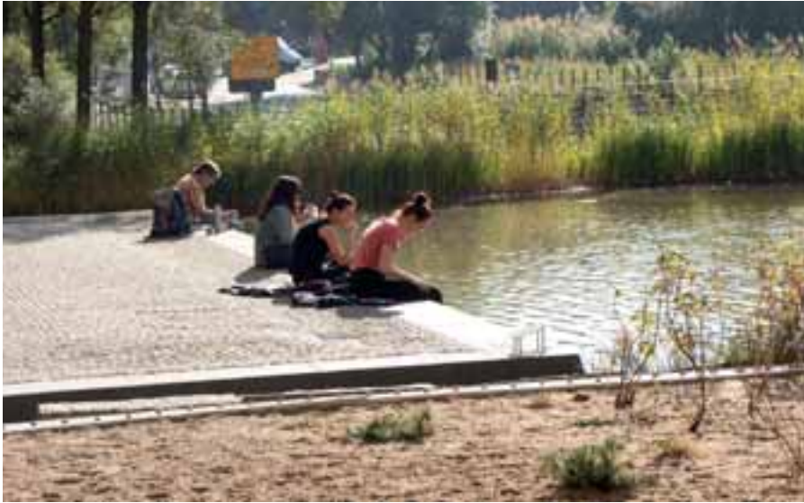
Abb. 4: Das „Urbane Gewässer“ am Potsdamer Platz in Berlin ist ein als Regenwasser-speicher angelegtes künstliches Wasserbecken. Die in den Reinigungsbeeten eingesetzten Wasserpflanzen tragen zur Verdunstung und Reinigung des Wassers bei. Der Wasserstand kann um insgesamt 30 cm schwanken, um Regenereignisse und Trockenperioden zu puffern. (Foto: Günther).
