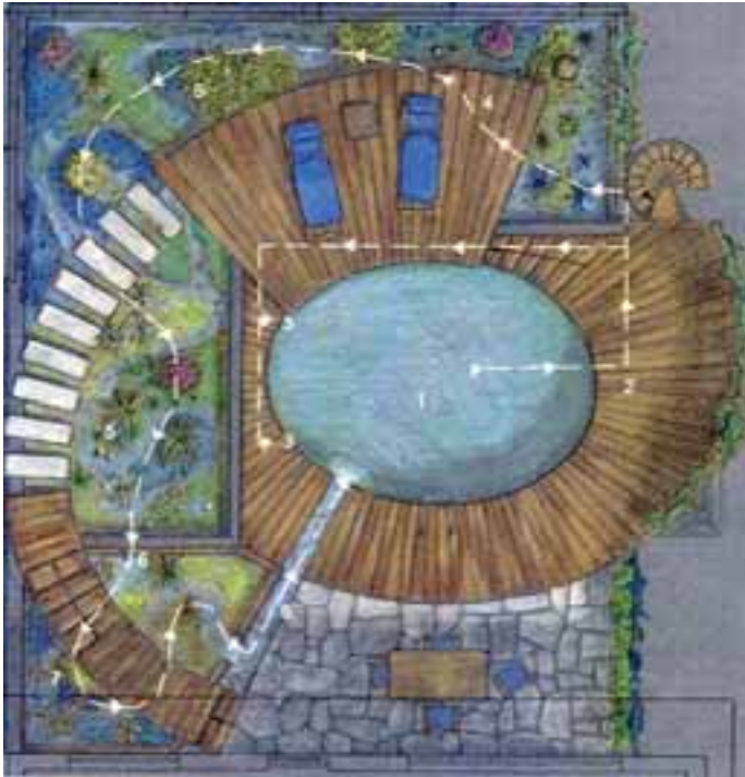
Abb. 2: Gestaltungsvorschlag für einen Schwimmteich mit flachgründiger Moorvegetation als Filterzone auf umgebender Dachfläche (Zeichnung: Wendorf, 2003). Der Schwimmteich ist mit dicker Betonwandung quasi als „Zimmer“ in das Gebäude integriert und über die Dachfläche zugänglich.
