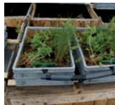
Abb. 19, 20, 21: Versuchsaufbau links (19): je 2 Filtermodelle (Tablets) wurden pro Kiste mit 2 ° Gefälle aufgestellt. Hinten ist die Wassereinspeisung (je zwei Einlässe pro Tablett) zu sehen. Vorn wurden die Tablets knapp über der Vegetationstragschicht gelocht. Mitte (20): Das untere Tablett wurde mit je einem Temperaturfühler bestückt. rechts (21): Mit der Variante „Reichmoor“ bepflanzen Tablets (Fotos: Kircher/Thon).
