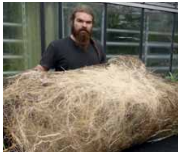
Abb. 1: Durchwurzelte Sumpfpflanzenmatte der Pilotanlage zur Grauwasserbehandlung (Foto: A. Zehnsdorf).
