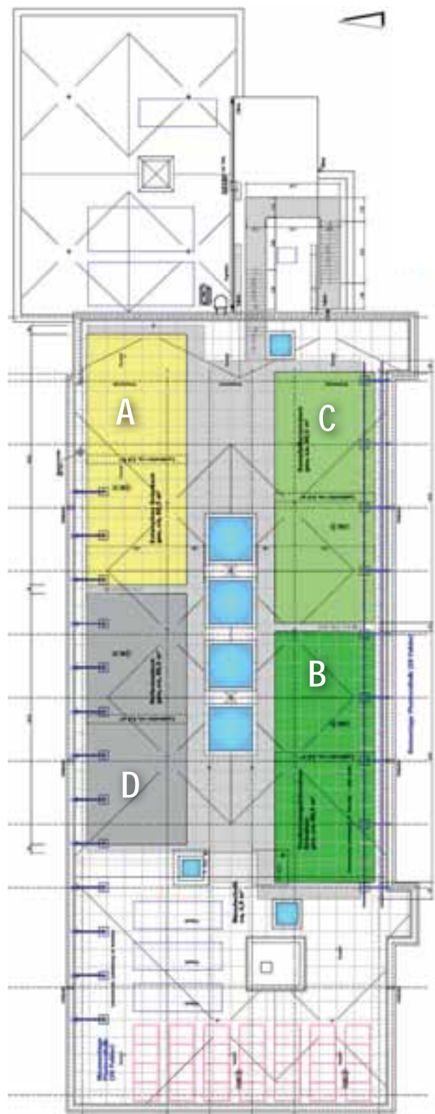
Abb. 7: Detailzeichnung Dachdraufsicht Pilotanlage Forschungsgründach (Zeichnung: BAUPLAN).
