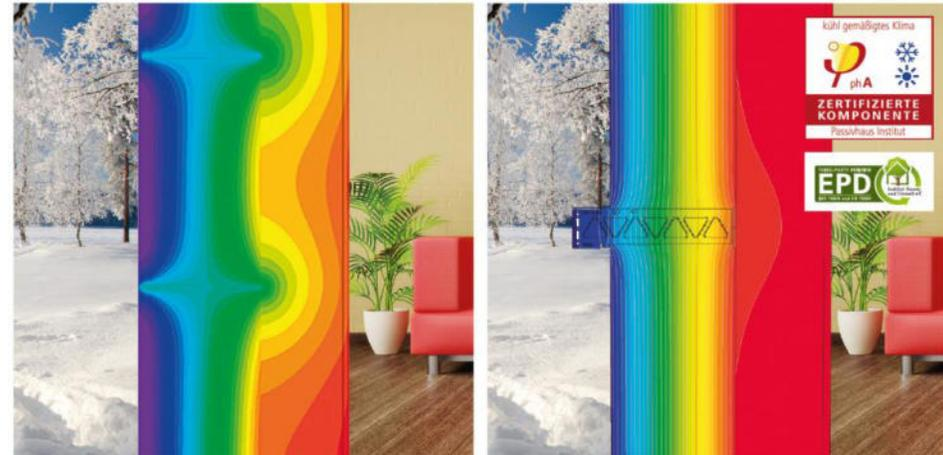
Abb. 1: Ausgeprägte Wärmebrücke bei Aluminiumkonsolen
